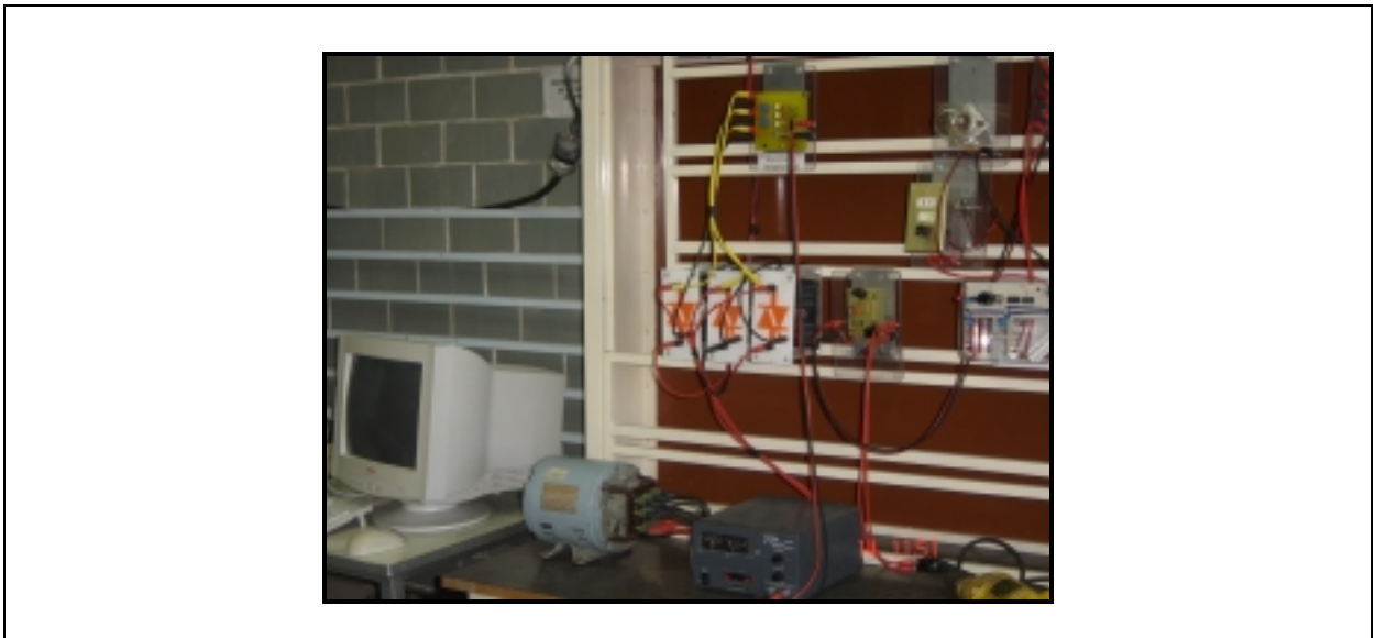
Figura 8. Conexionado del sistema de arranque y paro de un motor trifásico de corriente alterna.
